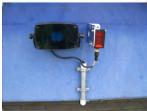
LKW`s werden schon in einer Entfernung von ca. 8 - 10 Metern erkannt und hierdurch optische und akustische Alarmgeräte aktiviert
